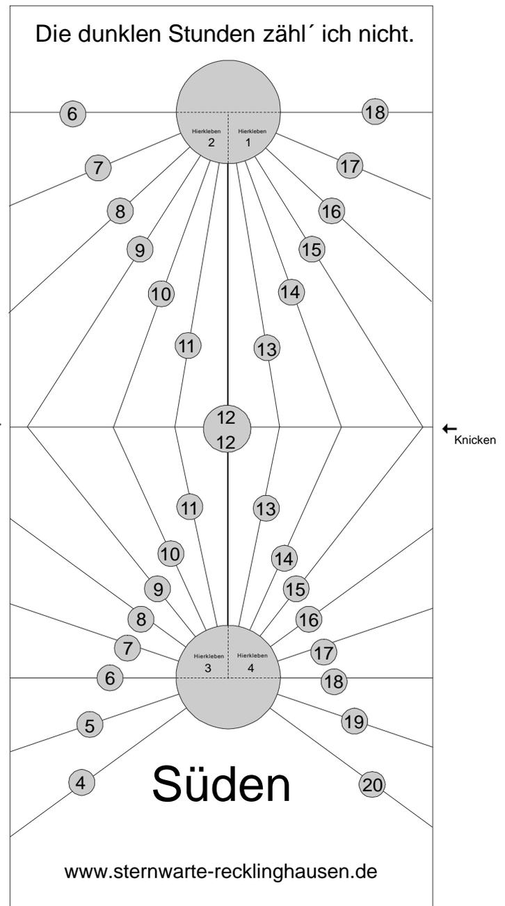
Ein dreieckiger Schattenwerfer verbindet eine senkrechte Sonnenuhr mit einer waagerechten. Die senkrechte Sonnenuhr zeigt die Zeit zwischen 6.00 und 18.00 Uhr, die waagerechte zwischen 4.00 und 20.00 Uhr an.
